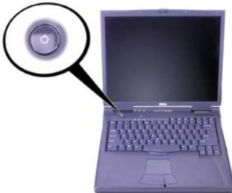
Figura 7-3. Encendido del ordenador
